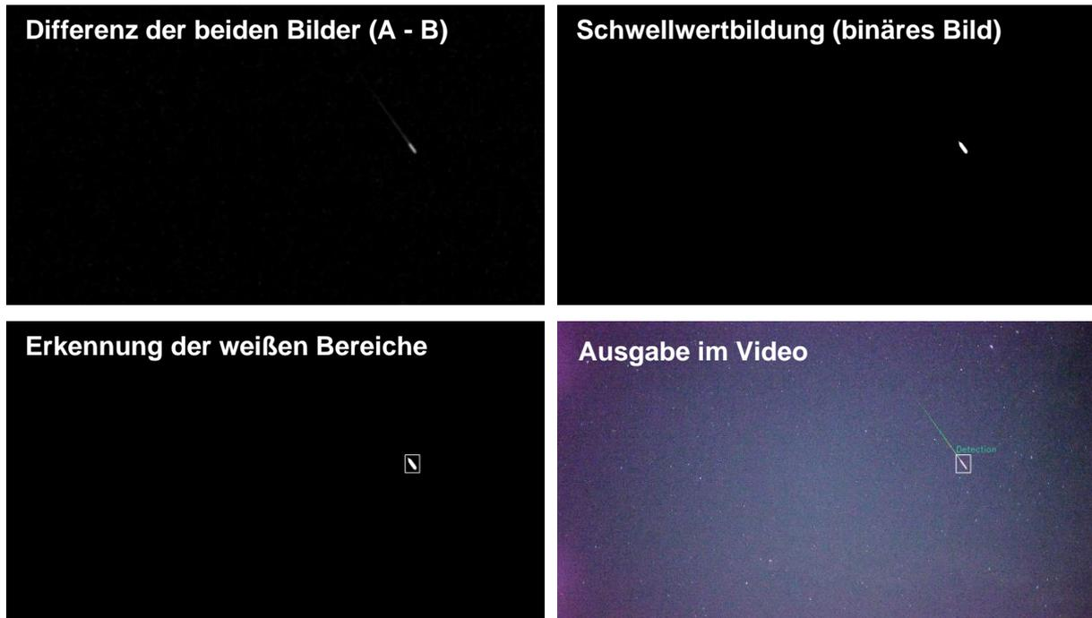
Abb. 3: Prozess zur Erkennung eines Meteors anhand eines Referenzbildes
