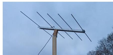
Abb. 2: Yagi-Uda-Antenne für GRAVES
